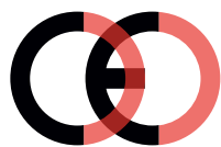
Faux marquage CE (trop proche)
